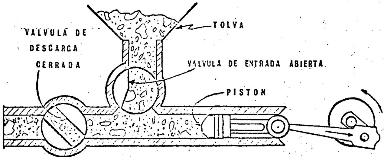
La válvula de entrada se abre cuando la válvula de descarga está cerrada y el concreto se introduce en el cilindro por gravedad y por la succión del pistón. Cuando el pistón se cierra la válvula de entrada, la válvula de descarga se abre, y el concreto es empujado por la tubería hacia la cimbra.
