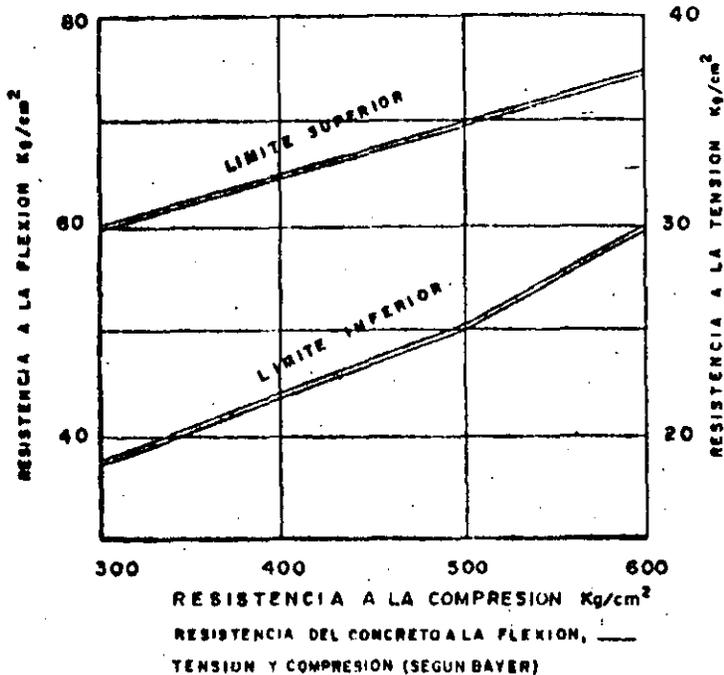
La adhesividad o adherencia del concreto es de primordial importancia en combinación con las resistencias al corte y a la flexión-tensión. Rabcewicz menciona que la resistencia al corte es 1.3 veces la resistencia a la flexión y el Instituto Sueco del Concreto (CBI) fija el valor de la adhesión en 10 a 15 kg/cm<sup>2</sup>.
