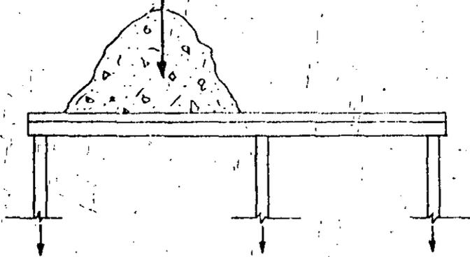
Las formas deben diseñarse para soportar este efecto, de no ser así deben construirse como simplemente apoyadas.
