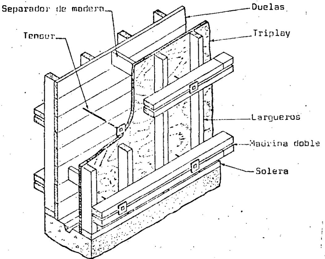
Ciebra típica para muro: Se muestran varias alternativas de materiales, el separador - con frecuencia, parte del - -
