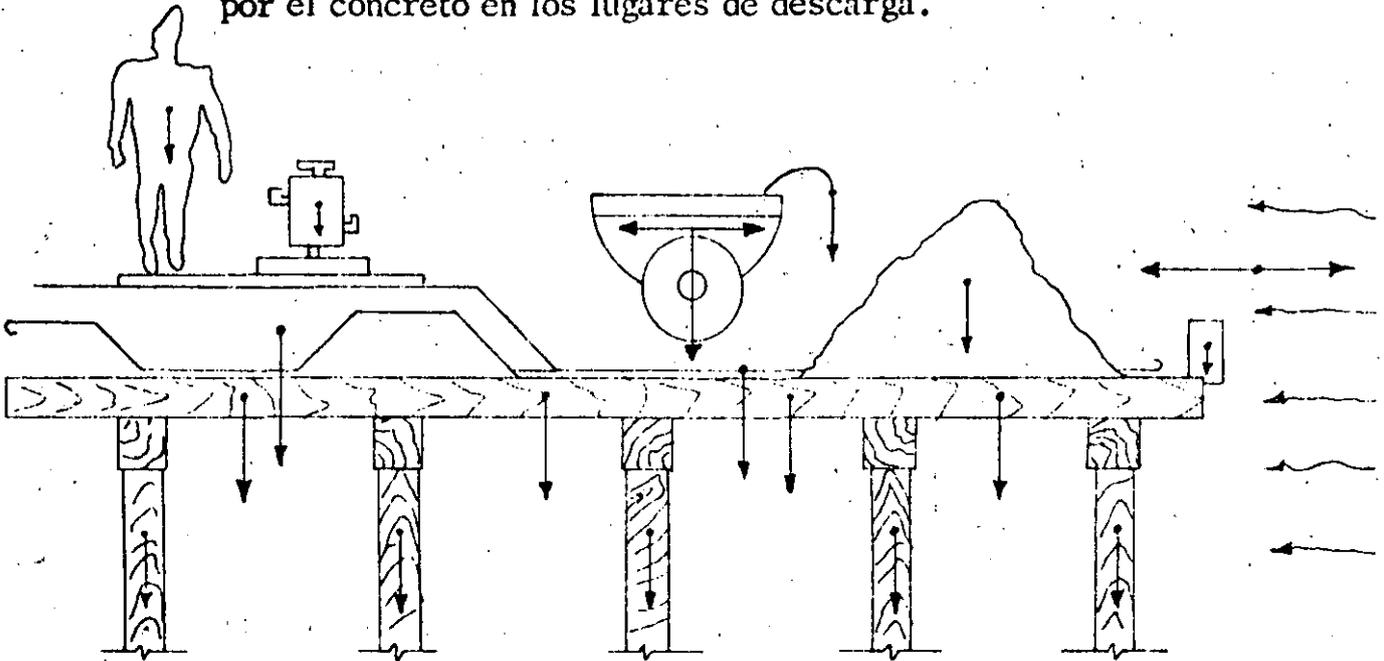
Peso propio: La cimbra de madera generalmente pesa de 50 a 75 kg/m<sup>2</sup>. Cuando este peso es pequeño en comparación con el peso del concreto + la carga viva puede despreciarse.
