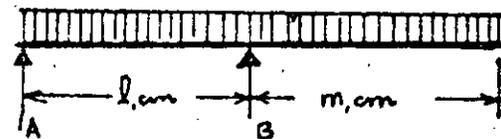
VIGA APOYADA EN AMBOS EXTREMOS, PERO SOBRESALIENDO UNO CON CARGA UNIFORME.
