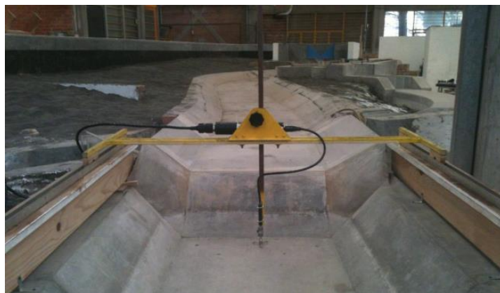
Figura 15 - Esquema de montaje del micro ADV
