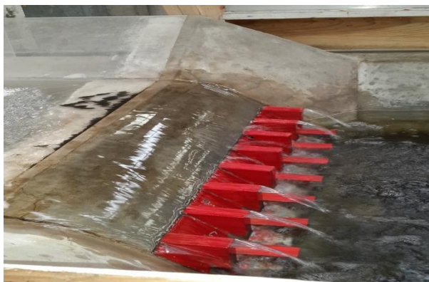
Figura 13 - Ensayo “Rápida dentada”
