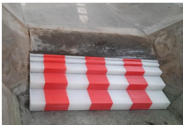
Figura 12 - Ensayo “Rápida escalonada”
