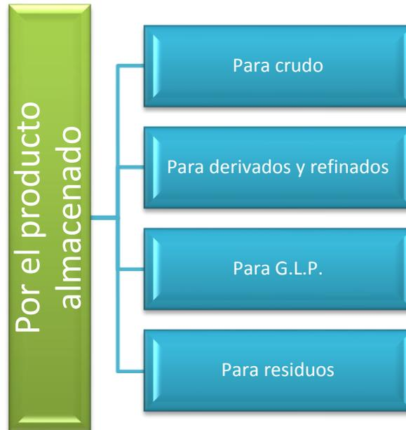
Figura 2. Clasificación de los tanques de almacenamiento por el producto almacenado.
