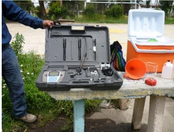
Figura 4.5. Equipo utilizado para el muestreo de agua subterránea (pozo San Luis 9) y de escurrimiento.
