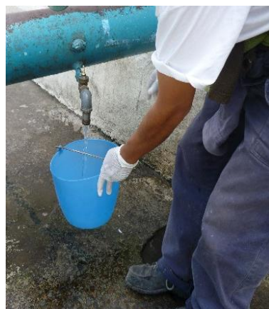
Figura 4.6. a) Toma de agua directamente de la llave del pozo; b) Medición de pH, K y T° de la muestra de agua vertida en el vaso de precipitados con ayuda del electrodo.
