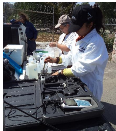
Figura 4.6. a) Toma de agua directamente de la llave del pozo; b) Medición de pH, K y T° de la muestra de agua vertida en el vaso de precipitados con ayuda del electrodo.
