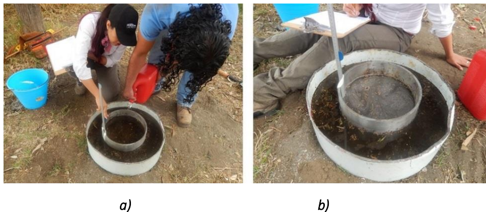
Figura 4.3. Prueba de infiltración; a) Nivelación del agua del anillo externo con la del anillo interno, b) Registro de datos observando el descenso del agua con ayuda de la regla estacada.
