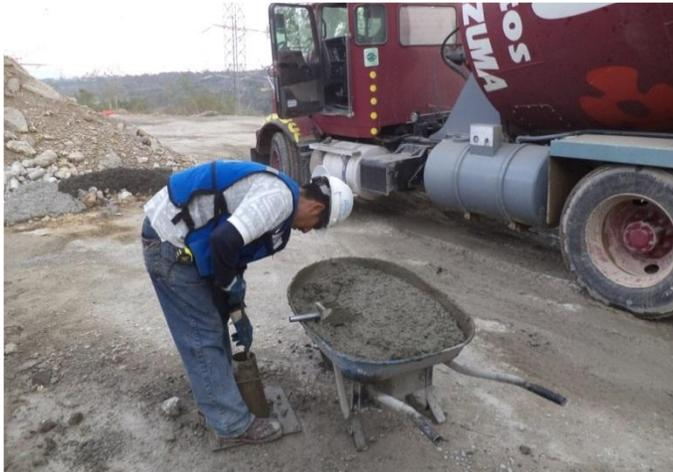
Prueba de revenimiento de concreto fresco.
