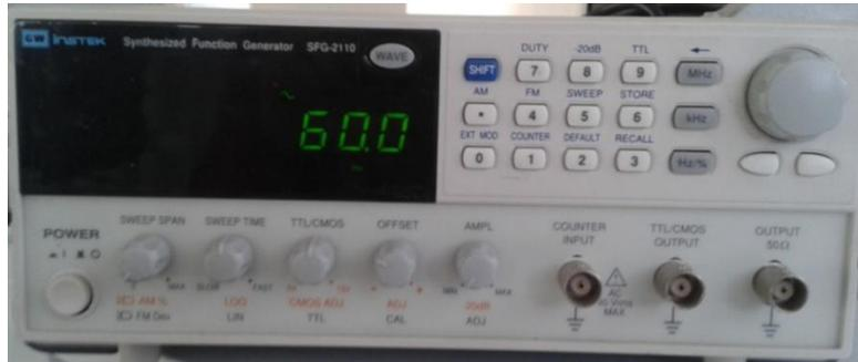
Figura 5.6 Generador de señales.
