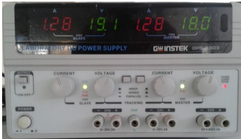
Figura 5.3 Fuente regulable de voltaje.
