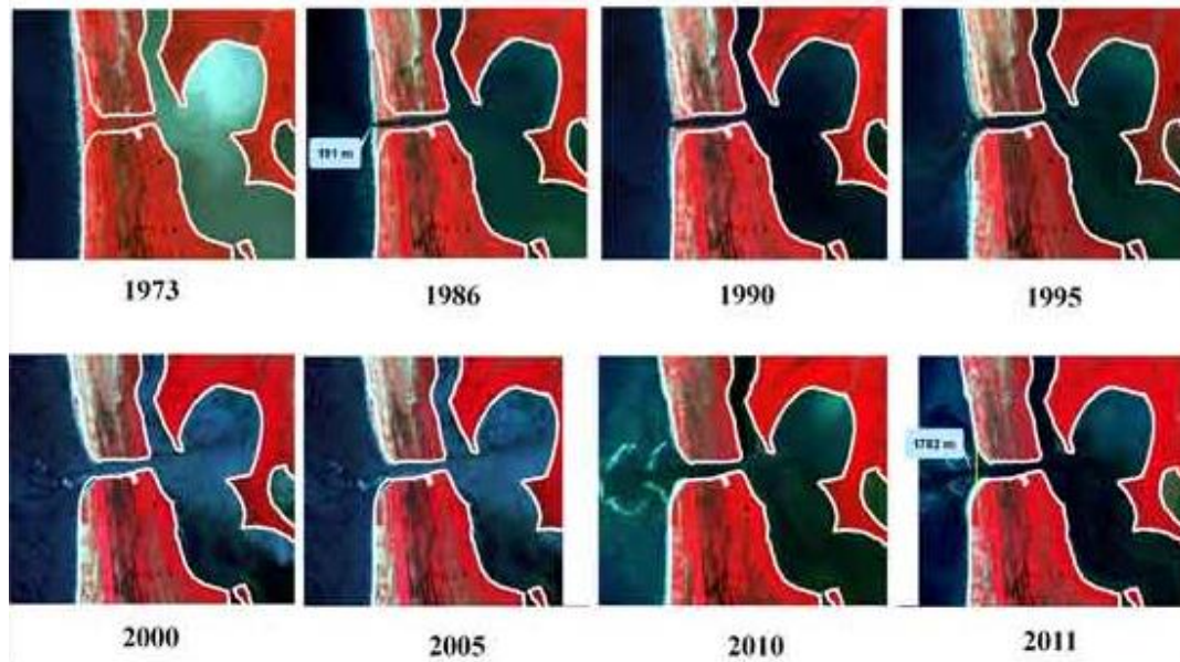
Figura 32. Evolución del canal de Cuautla a través de imágenes de satélite Landsat (Berlanga, 2012).
