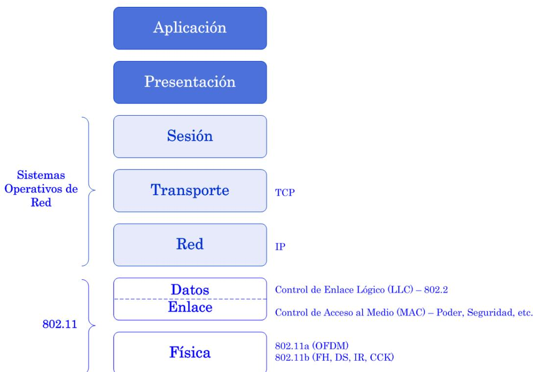
Figura 2.1 802.11 y el Modelo de Referencia OSI
