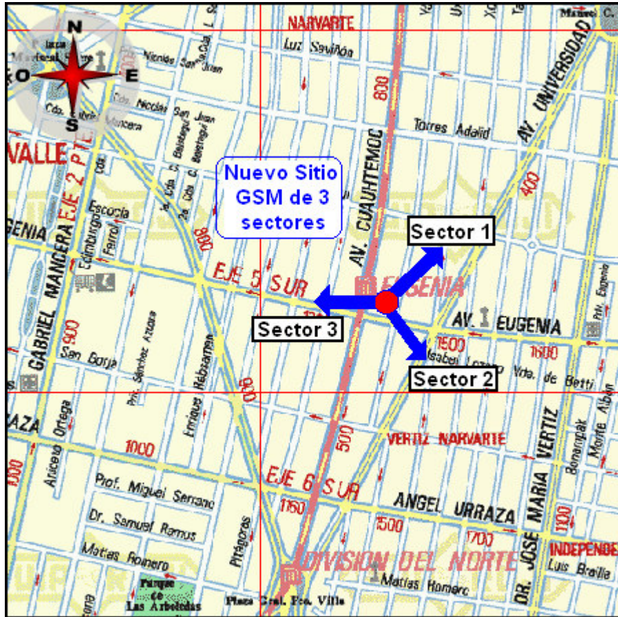
Figura 3. Ejemplo de un nuevo sitio celular GSM con 3 sectores
