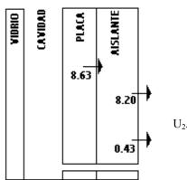
$$U_2A(Tp - Tw) - hr_2A(Tw - T\alpha) - hc_2A(Tw - T\alpha) = 0$$
