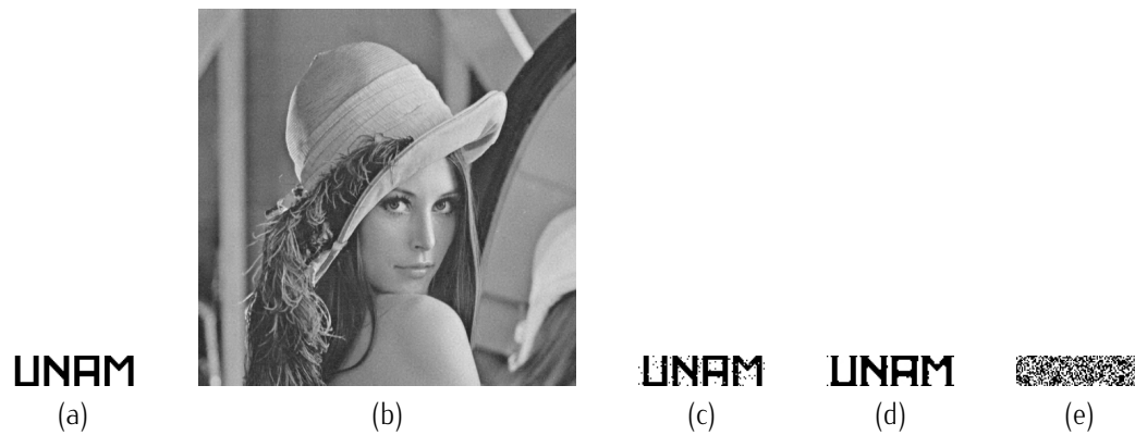
Figura 4.11: Gráfico de los logos original y recuperado de la imagen marcada utilizando el segundo método. (a) muestra el logo original. (b) muestra la imagen marcada. (c) muestra el logo recuperado. (d) muestra el logo recuperado después de un filtro de mediana y (e) muestra un logo recuperado sin una llave autorizada.
