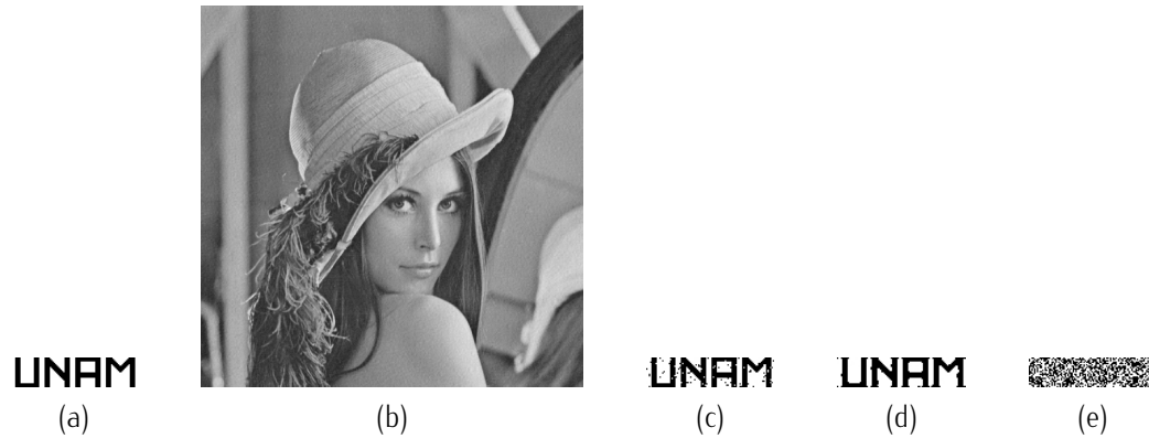
Figura 4.10: Gráfico de los logos original y recuperado de la imagen marcada utilizando el primer método. (a) muestra el logo original. (b) muestra la imagen marcada. (c) muestra el logo recuperado. (d) muestra el logo recuperado después de un filtro de mediana y (e) muestra el logo recuperado sin una llave autorizada.
