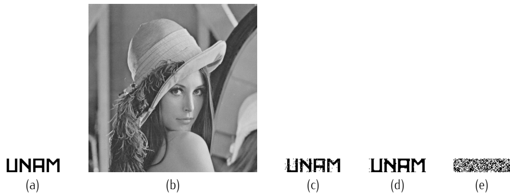
Figura 4.13: Gráfico de los logos original y recuperado de la imagen marcada utilizando el cuarto método. (a) muestra el logo original. (b) muestra la imagen marcada. (c) muestra el logo recuperado. (d) muestra el logo recuperado después de un filtro de mediana y (e) muestra un logo recuperado sin una llave autorizada.
