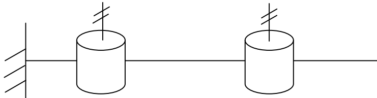
Imagen 8. El manipulador se muestra de forma esquemática simple, las marcas de referencia en los ejes indican que son mutuamente paralelos.
