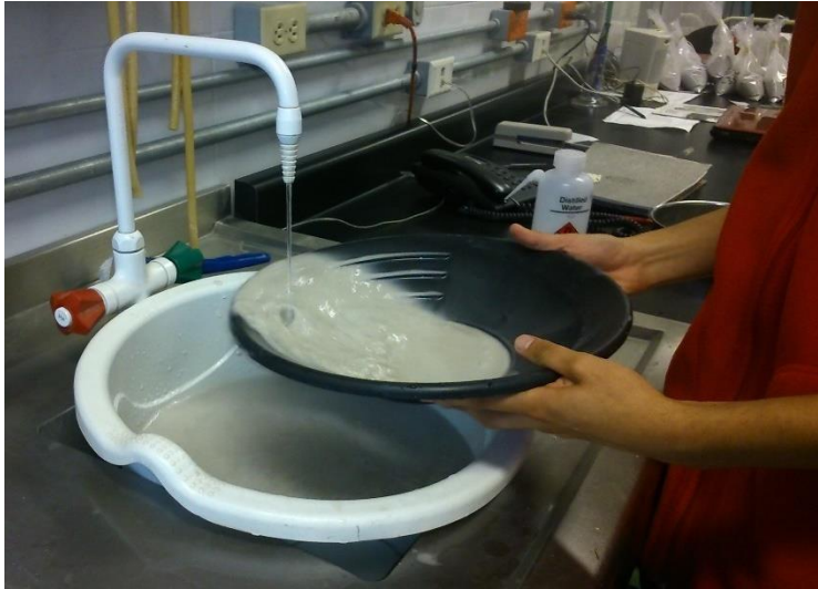
Figura 3.4 Método de concentración por batea. Se muestra un plato tipo "pan californiano" con una serie de escalones que impiden la pérdida de minerales más densos.
