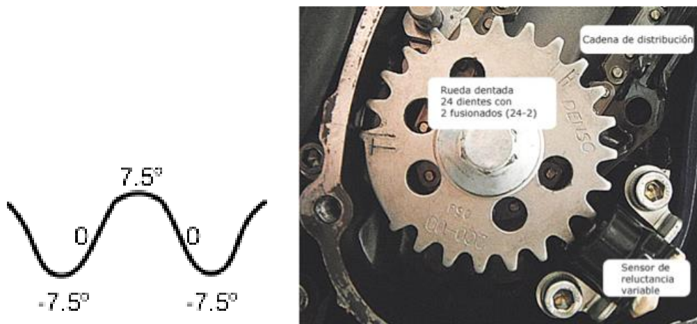
Figura 4.2 Rueda dentada del cigüeñal
