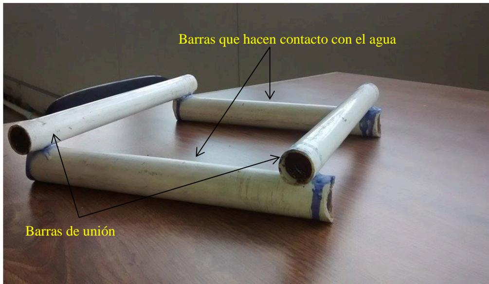
**Figura 3.20.-** Detalle de flotador “balsa”
