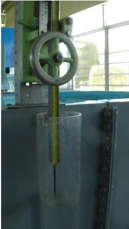
**Figura A.5** Limnómetro de vertedor triangular
