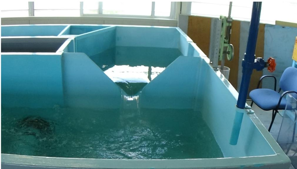
**Figura A.4** Vertedor triangular en funcionamiento
