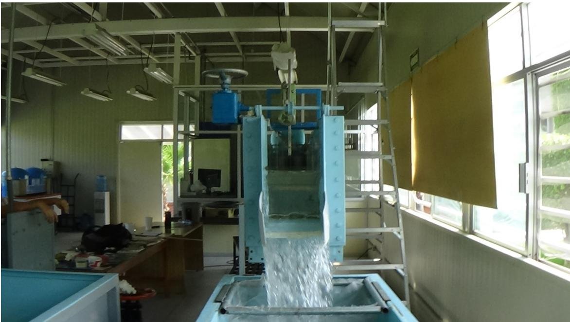
**Figura 3.22.-**Canal con vertedor en funcionamiento
