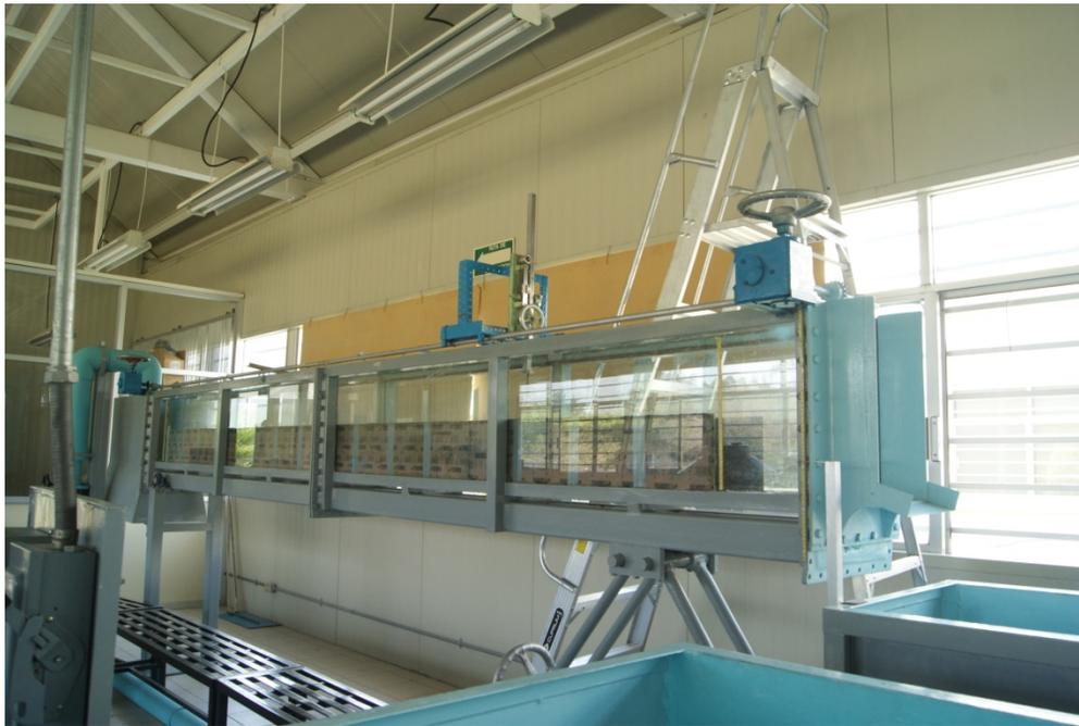
**Figura A.2** Canal de pendiente variable
