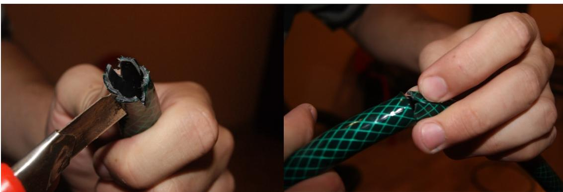
**Figura 3.4.-** Demostración de la fabricación de aros flotadores.
