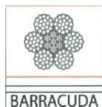
Figura 3.12. Corte transversal de tipo de cable utilizado
