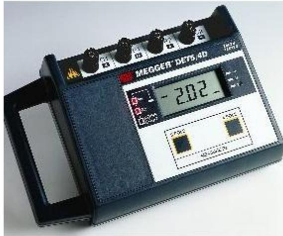
Los telurómetros inyectan una corriente de frecuencia diferente a 60 Hz para evitar se midan voltajes y corrientes de ruidos eléctricos. Los telurómetros tienen cuatro terminales: 2 de corriente (C1, C2) y 2 de potencial (P1, P2) que están marcadas en el aparato C1 P1 P2 C2.
