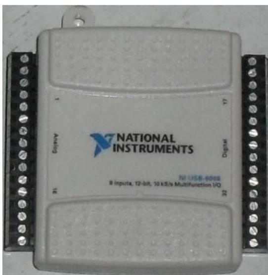
Figura 69: Tarjeta de adquisición de datos.
