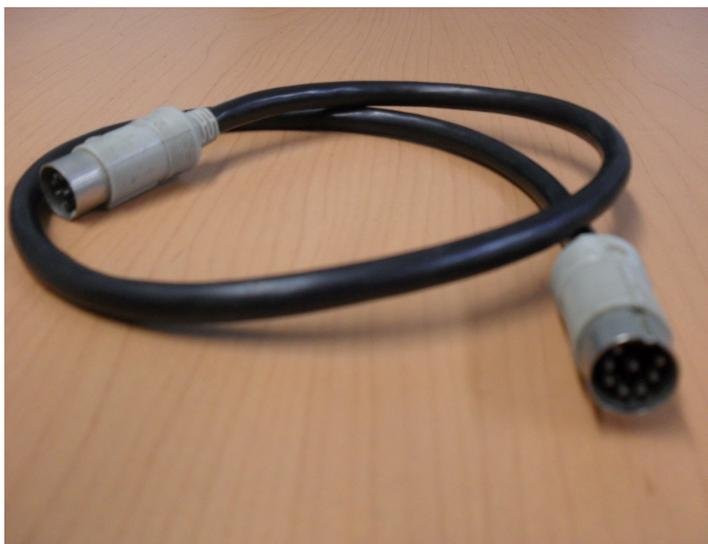
Figura 43: Cable DIN 8.
