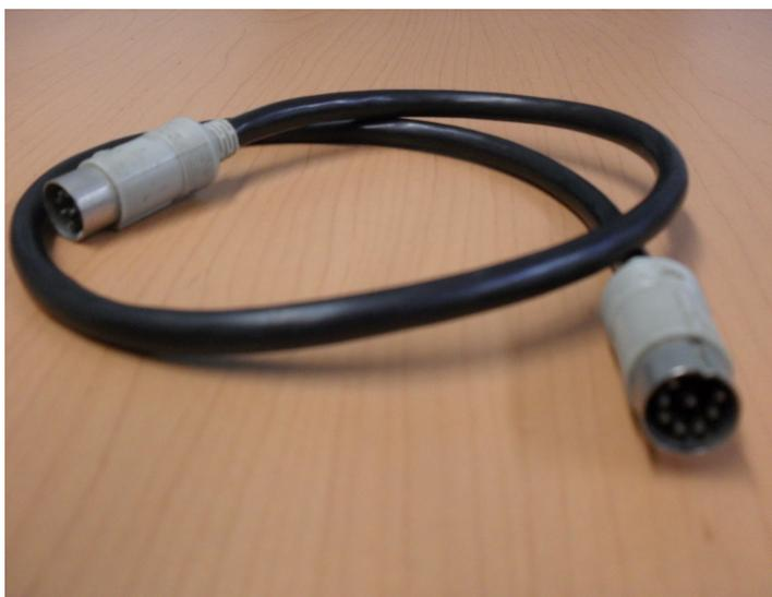
Figura 67: Cable DIN 8.
