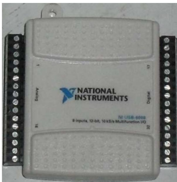
Figura 45: Tarjeta de adquisición de datos.
