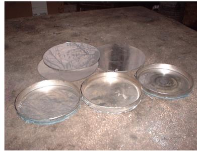
Figura 1.5 Discos torneados para formar el fondo del bote
