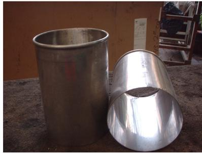
Figura 1.4 Cilindro con doble dobles, rolado para la fabricación de bote
