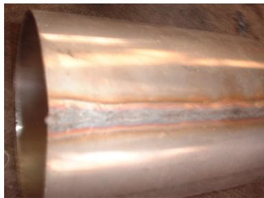
Figura 1.6 Soldado de bote con soldadura tipo TIG
