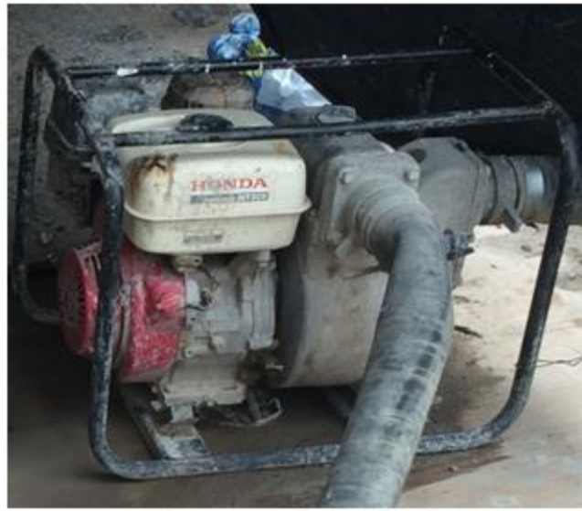
Fig. 2.41, Bomba de Diesel
