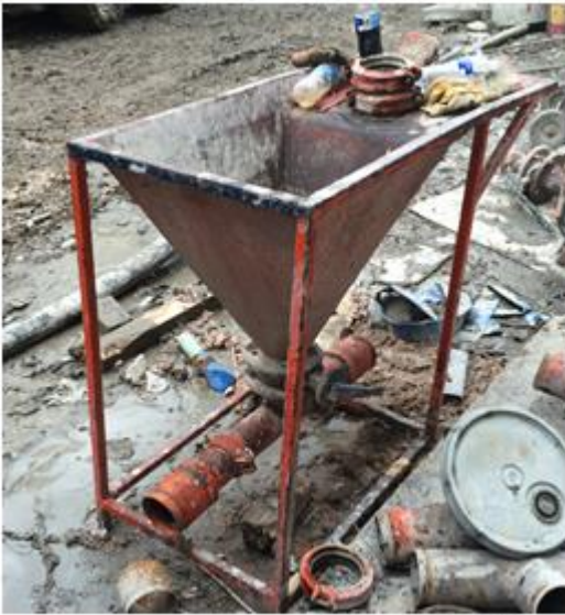
Fig. 2.40, Mezclador de Chiflón
