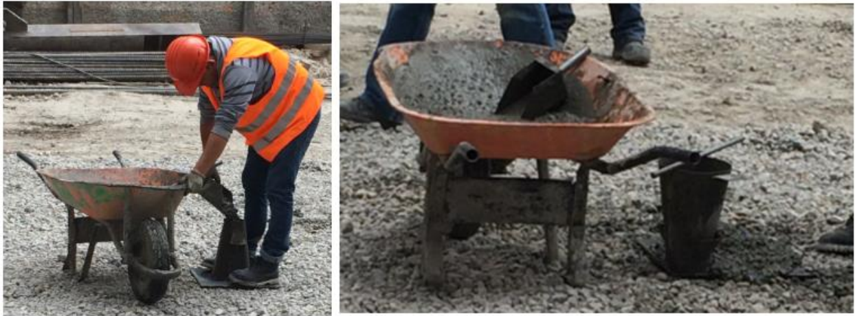
Fig. 4.15, Prueba de Revenimiento
