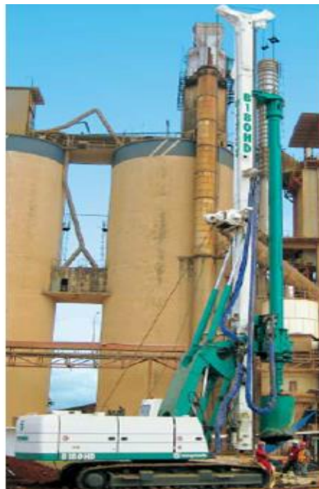
Fig. 1.20, Perforadora Rotatoria B180HD CASAGRANDE
