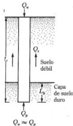
Figura 1.6, Pilas de Punta con Empotramiento
