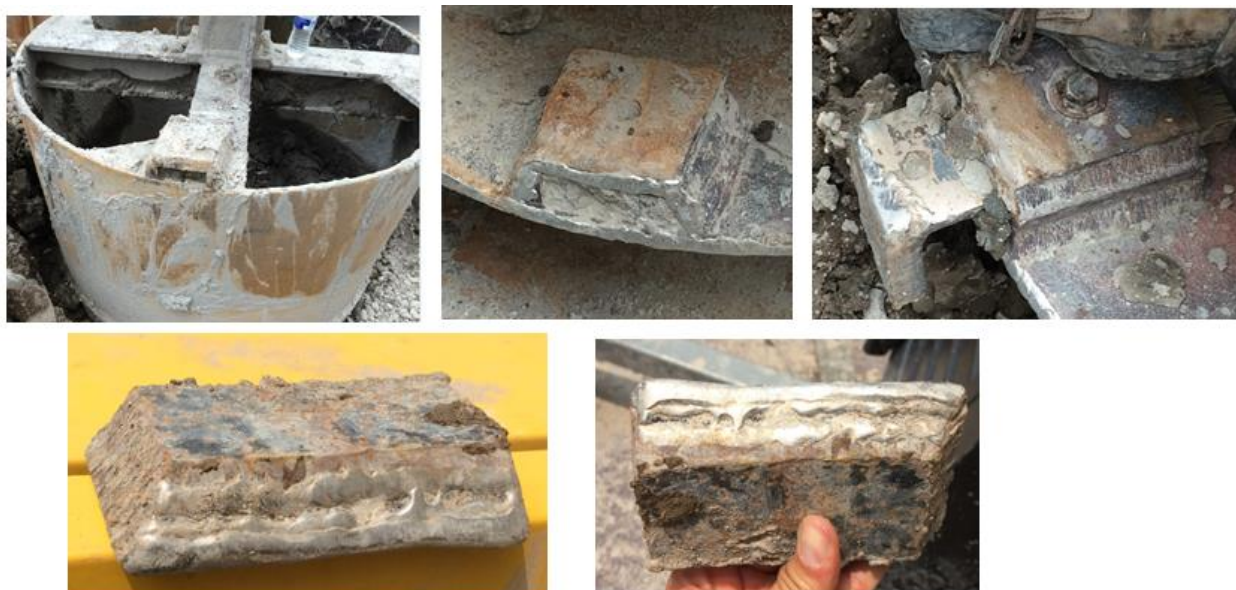
Fig. 2.36, Dientes (Rimas), Porta Dientes (Caja Metálica)
