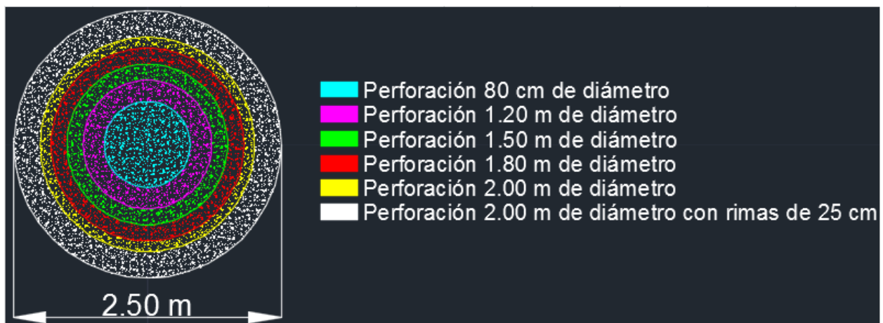
Fig. 2.35, Esquema de Excavación
