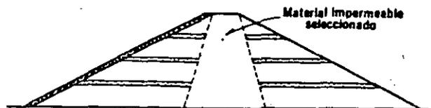
Fig 4.15 Drenes horizontales para reducción de presiones de poro durante la construcción
