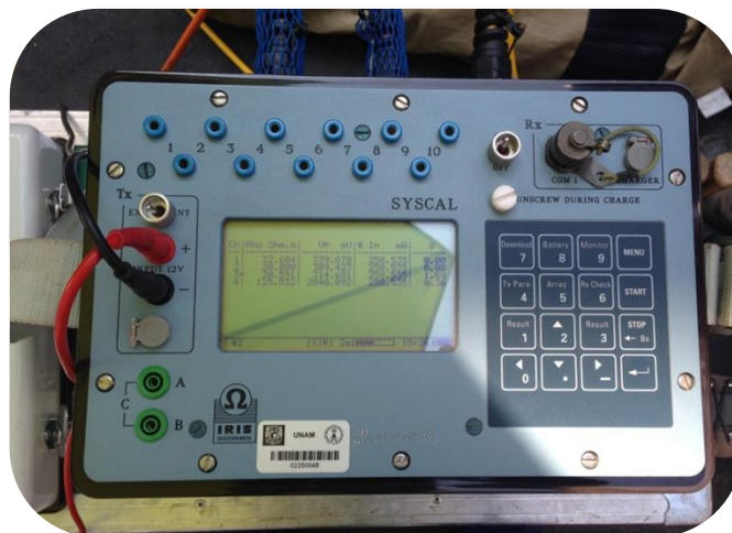
Figura (4.3). Resistivímetro Syscal Pro Switch 48.
