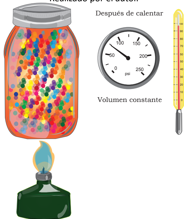
Fig. 1.3 Volumen constante de gas experimentado aumento de presión cuando se calienta.
