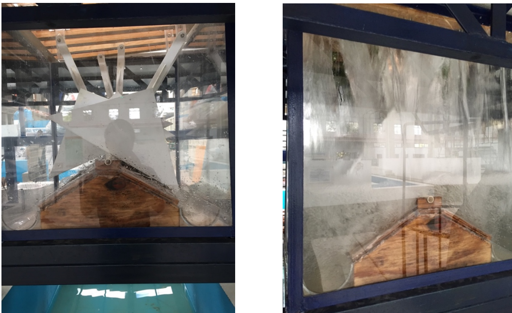
Figura 75 Boca de tormenta autolimpiable en funcionamiento.
