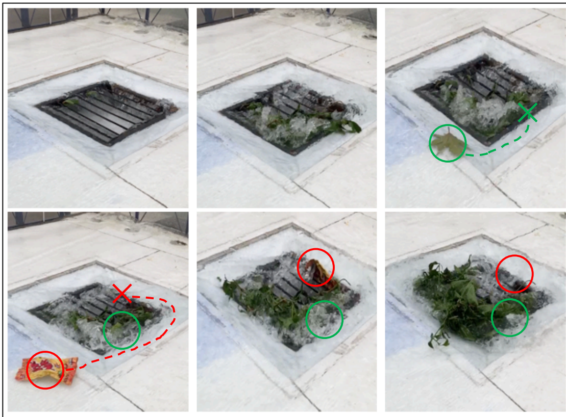
Figura 79 Ensayos para el trazado de la trayectoria de desechos en la boca de tormenta
