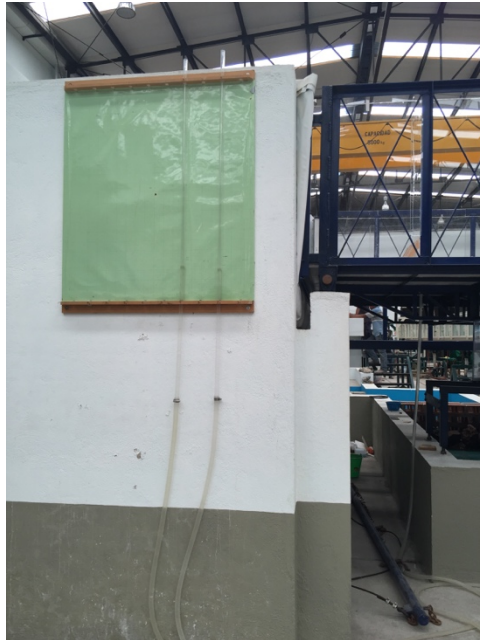
Figura 47 Piezómetros para la medición del tirante aguas arriba y aguas abajo de la boca de tormenta
