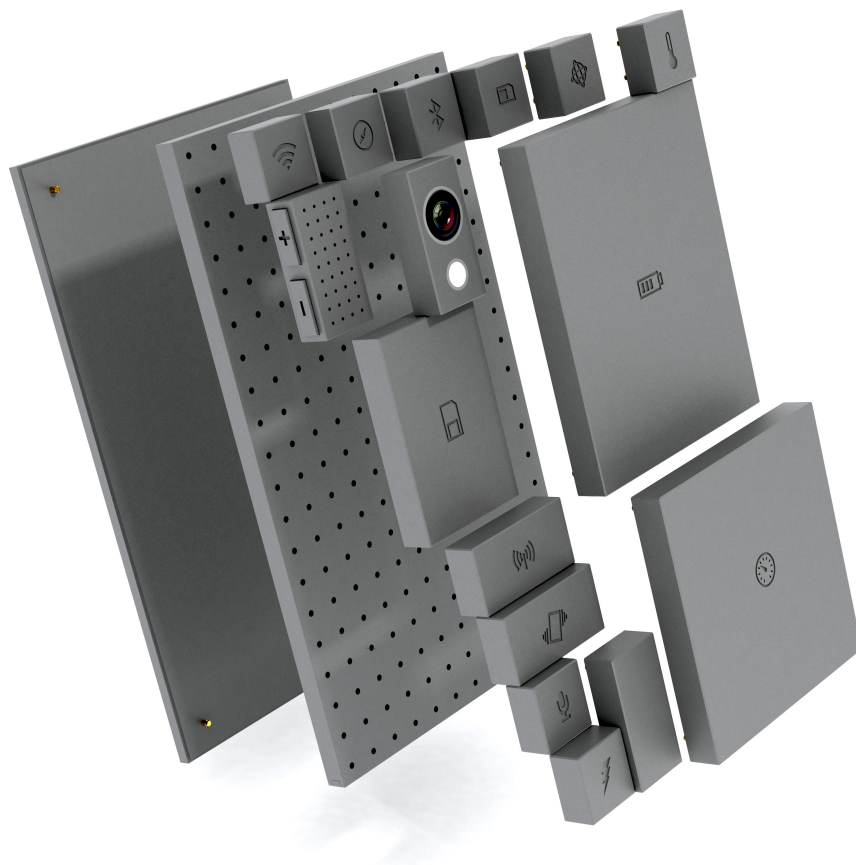
Figura 2.4: Concepto de diseño de Phonebloks, un celular totalmente modular, propuesto por Dave Hakkens [25].
