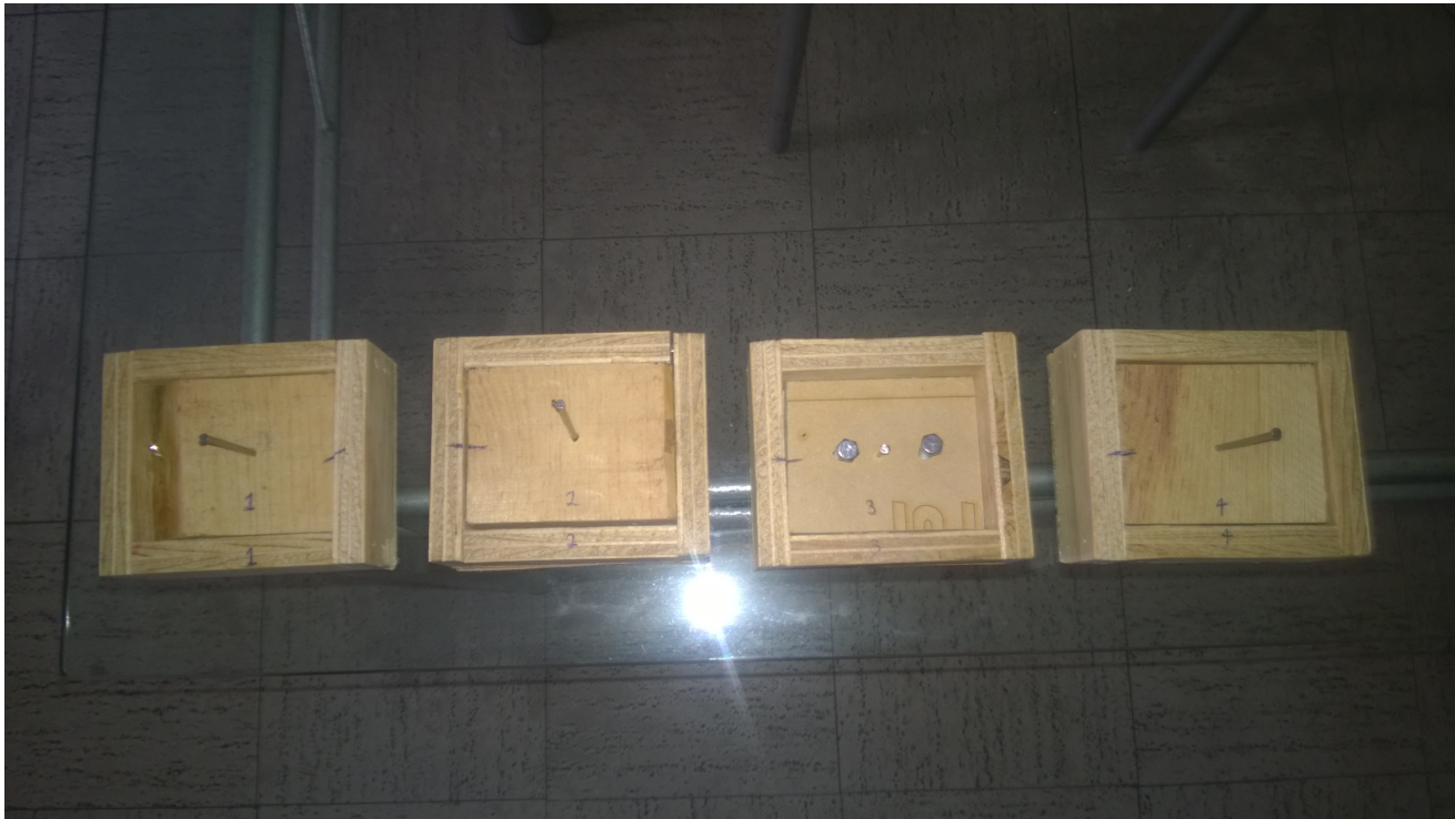
Figura 3.15: Modelos de madera (mock up) contruidos para ayudar a seleccionar el mejor concepto. 1) El tipo de conexión mecánica es por fricción. 2) Conexión mecánica con imanes. 3) Conexión mecánica con tornillos y tuercas. 4) Conexión mecánica con mecanismo de empuje (concepto basado en el mecanismo de lectores de tarjetas de memoria SD).
