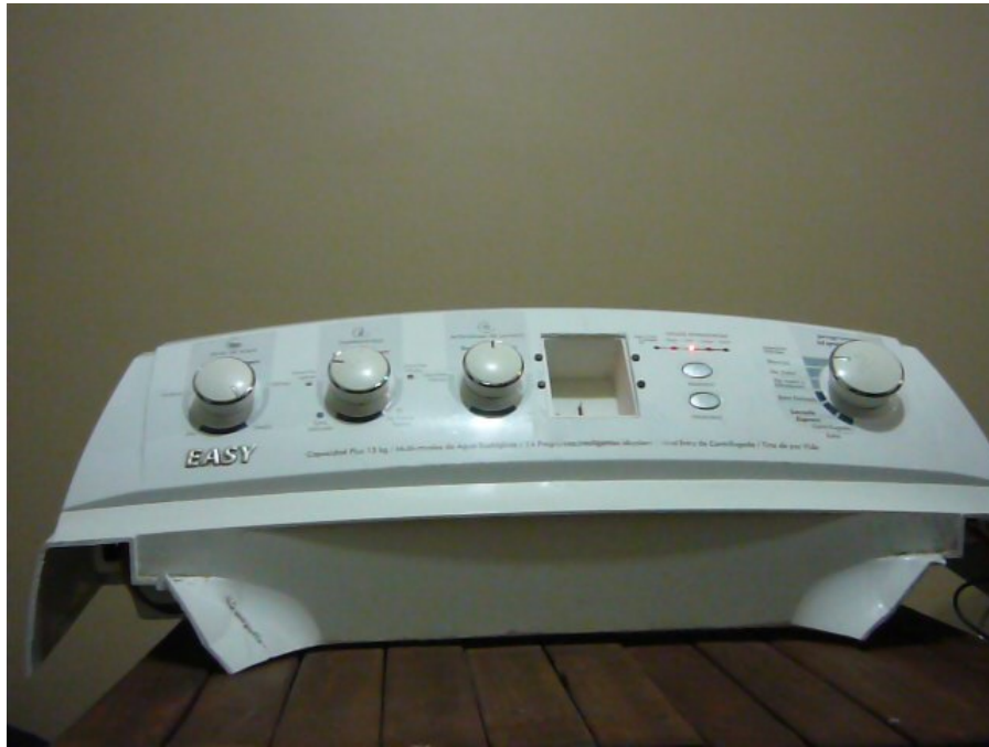
Figura 5.3: Panel de control de la lavadora con el receptor ensamblado. Se modificaron la carcasa y el interior de la lavadora para poder conectar los cables internos hacia el receptor.
