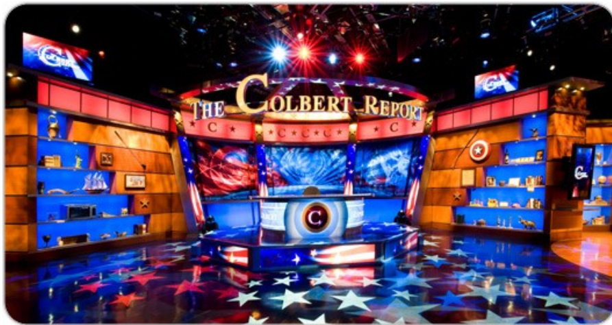
Figura 2.8: Christie MicroTiles en funcionamiento en un noticiero. Son pantallas modulares que muestran de manera sincronizada una gran imagen, y se pueden colocar de la manera que le sea más conveniente al usuario. Se aprecia como la arquitectura modular brinda la flexibilidad para construir una pantalla del tamaño del escenario [35].
