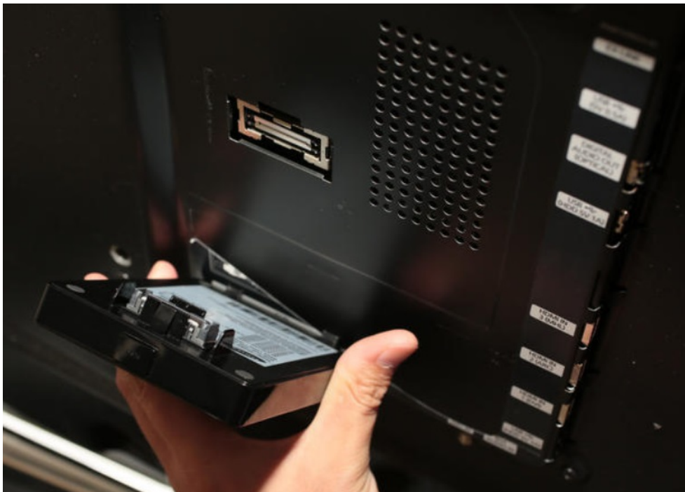
Figura 2.2: Instalación del Evolution Kit en la parte posterior de una Smart TV [23].
