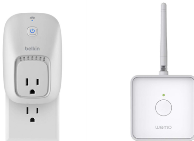
Figura 2.9: Dispositivos WeMo. A la izquierda, WeMo Switch, el cual se conecta entre un contacto eléctrico y la clavija de un electrodoméstico, y permite controlar el encendido o apagado de éste por medio de internet. A la derecha, WeMo Maker, este permite controlar dispositivos electrónicos de 24 V o 24 W máximo, mediante un relevador controlado por internet.
