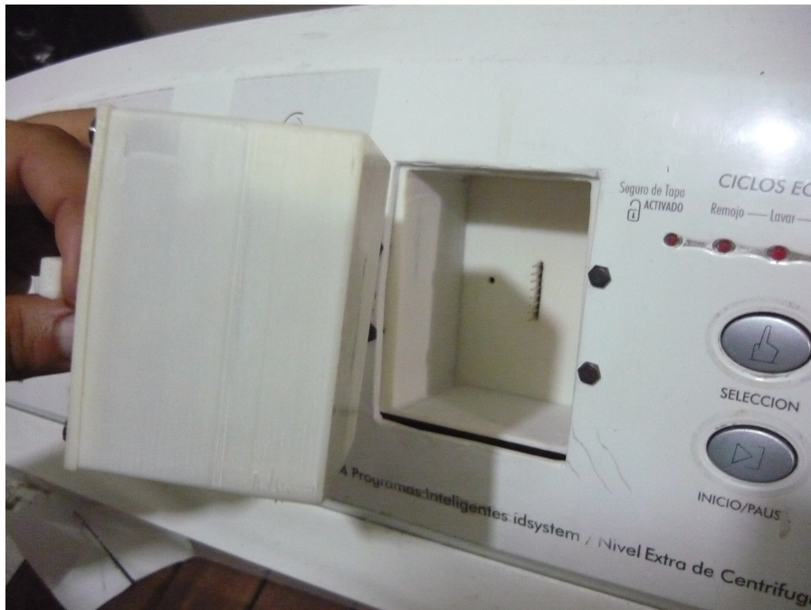
Figura 5.4: Módulo de Smapp justo antes de ser instalado en el panel de control de la lavadora. Sólo se necesita una mano y poco esfuerzo para poder instalarse.
