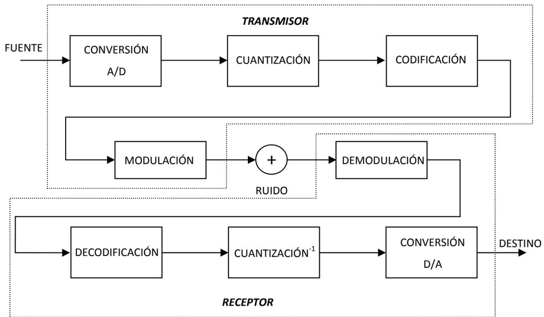
FIG. 3.4 DIAGRAMA DE BLOQUES DE UN SISTEMA DE COMUNICACIONES
