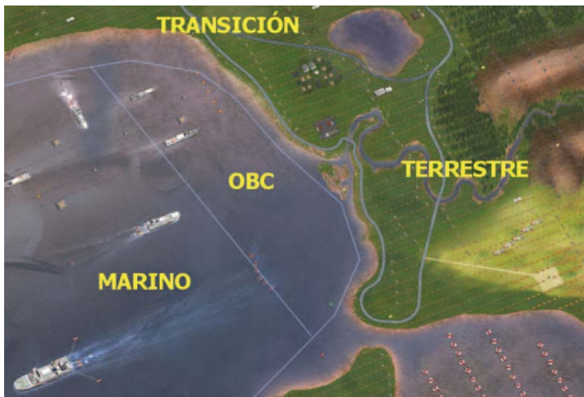
Figura II.2 Tipos de levantamientos sísmicos.
