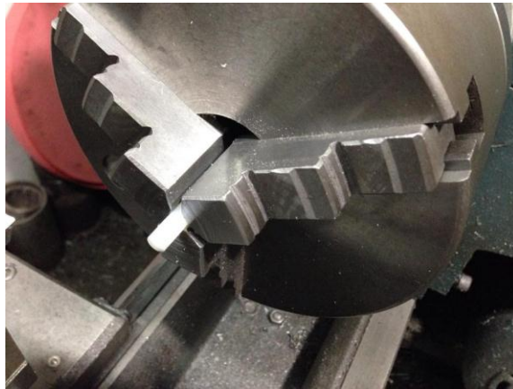
FIG. 42 TORNEADO DE EJES EN MATERIAL NYLAMID
