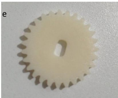
FIG. 41 IMÁGENES DE ALGUNAS PIEZAS FABRICADAS EN LA IMPRESORA MOJO. A) CORONA CÓNICA B)BIELA C) PIÑÓN CÓNICO D) PIÑÓN Y CORONA PLANOS E) CORONA PLANA F) MANIVELA.
