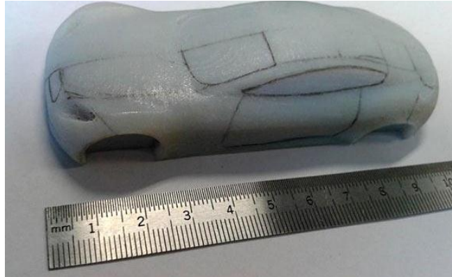
Figura 7 Impresión de chasis por el método FDM
