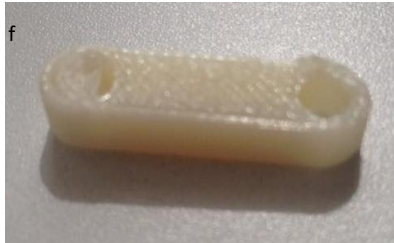
FIG. 41 IMÁGENES DE ALGUNAS PIEZAS FABRICADAS EN LA IMPRESORA MOJO. A) CORONA CÓNICA B)BIELA C) PIÑÓN CÓNICO D) PIÑÓN Y CORONA PLANOS E) CORONA PLANA F) MANIVELA.
