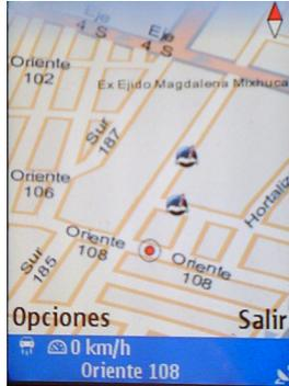
Fig.22 En esta imagen podemos ver que ya se ha determinado la posición del usuario, por eso la imagen del cursor se despliega de forma distinta en un punto rojo. (Nokia 6110)
