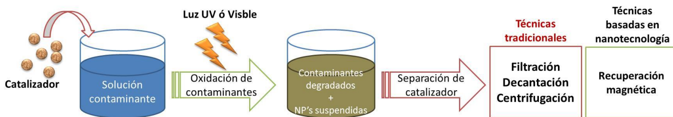
Figura 4.4. Esquema del proceso de fotocatalisis con las diferentes opciones de recuperación de catalizadores.
