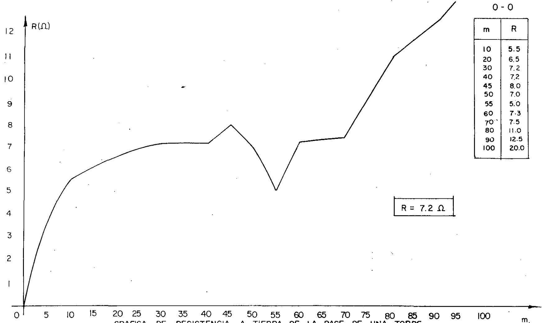
GRAFICA DE RESISTENCIA A TIERRA DE LA BASE DE UNA TORRE DE TRANSMISION DE 69 KV, SIN HILO DE GUARDA.
