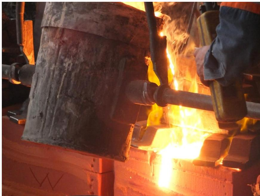
Figura 1.17. Vaciado de acero fundido
