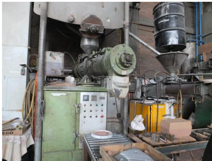
Figura 1.6. Máquina revoladora de arena.
