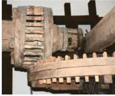
**Fig. 4.17 Engranajes helicoidales de madera.**
