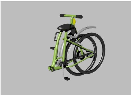
Fig. 4.12 Juntar ambos extremos.
