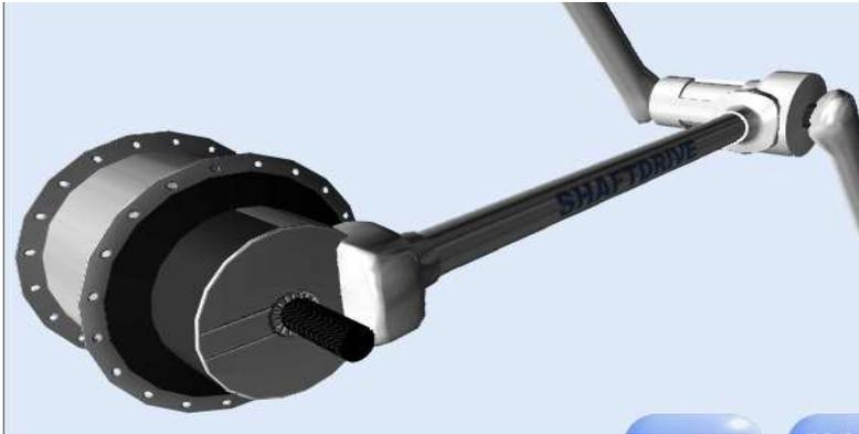
Fig. 3.3 Sistema de cardán (Shaft Drive).
