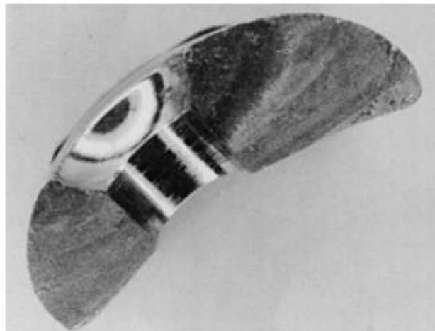
**Figura 5.26(h).** Fractura por fatiga por compresión del tornillo sobre el implante ortopédico.<sup>[20]</sup>
