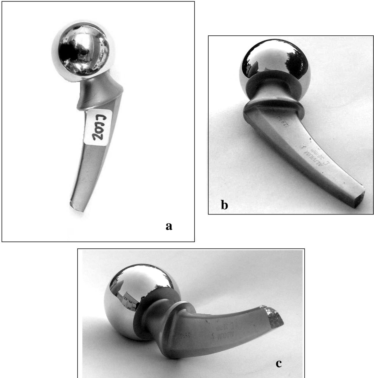
Figura 5.3 (a, b y c) Prótesis femoral de aleación de cobalto-cromo, vista en diferentes ángulos.
