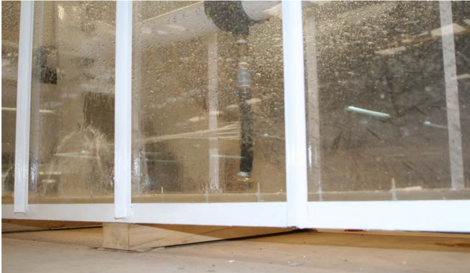
Figura 3.3. Imagen de la fuga en la probeta, la cual fue tomada en una de las mediciones experimentales.
