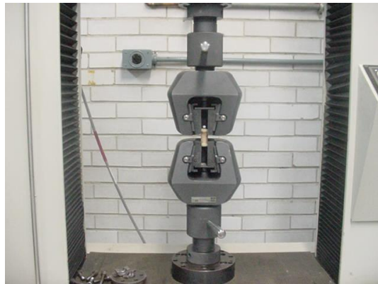
Figura. 4.4 Muestra colocada en las mordazas de la máquina universal de pruebas INSTRON
