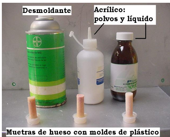
Figura. 4.3 Encapsulamiento de la muestra con PMMA
