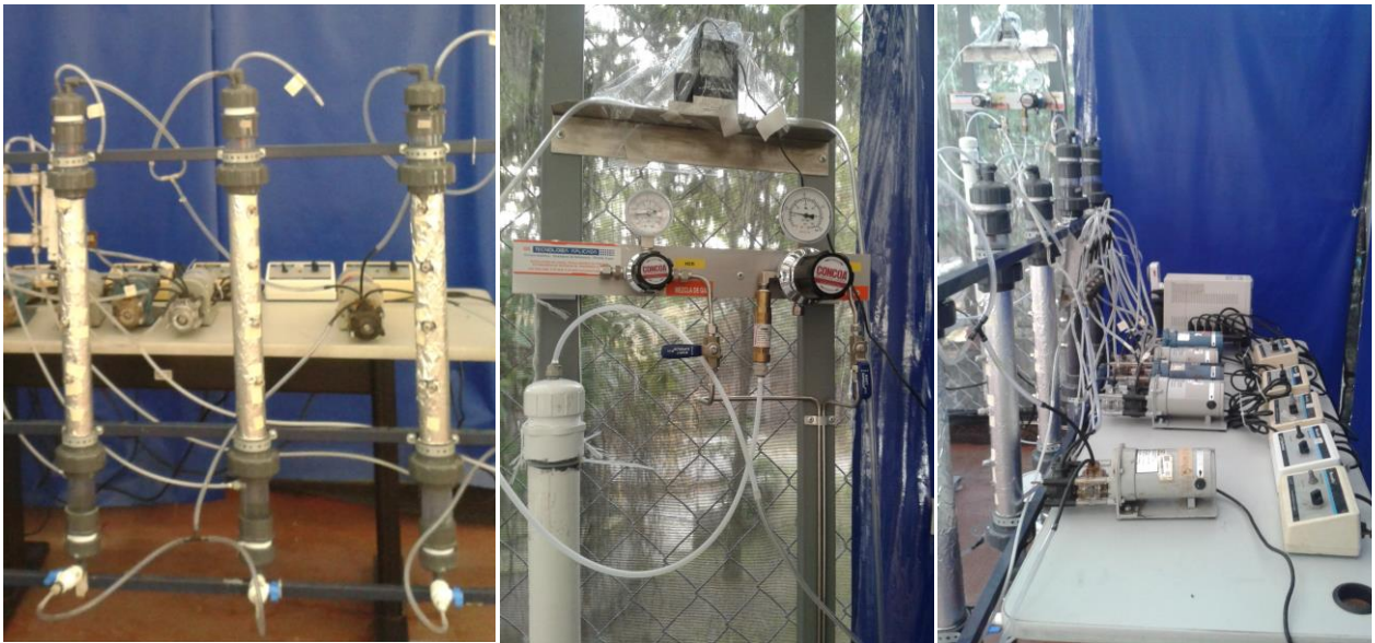
Figura 4. 3 Operación del sistema de biofiltración utilizado en régimen continuo (la bolsa Tedlar se utiliza para muestrear la salida de la corriente gaseosa tratada).
