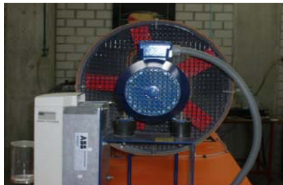
Fig. 2.8 Ventilador al final del túnel
