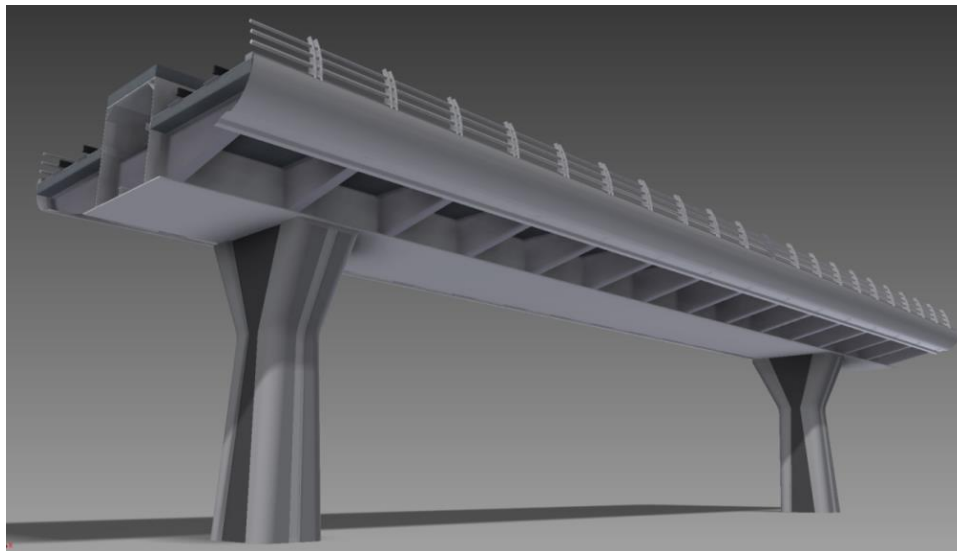
Sección de tablero metálico.
