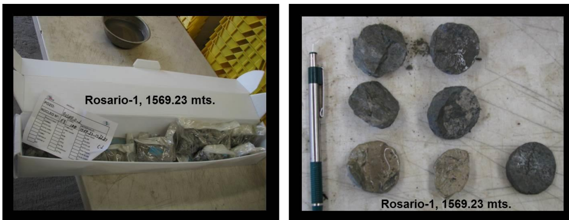
Figura 3.3.1.3.-Fragmentos de Nucleo-1 del Pozo Rosario-1, en el cual se observan los fragmentos de lutita color gris con algunas intercalaciones de areniscas de color café claro. La batimetría es de batial inferior. Probablemente facies de cuenca. Tomado de Plays Huimanguillo 2011.
