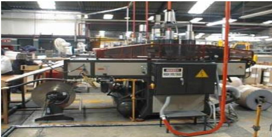
Figura 4.3 Máquina de termoformado
