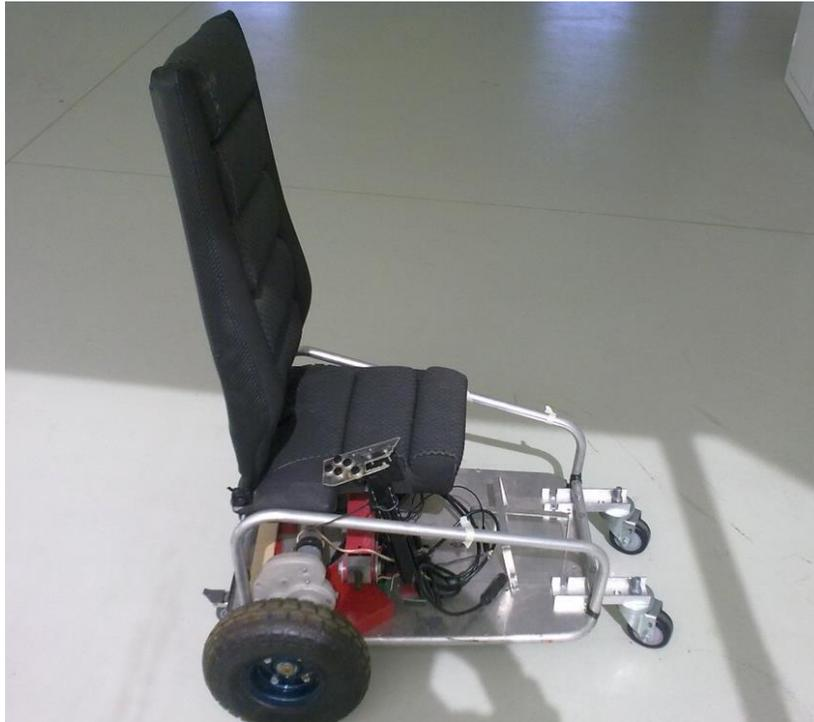
La posición del asiento se encuentra en el centro de masa del vehículo, el cual se ubica entre las ruedas delanteras y las de tracción. El diseño se basa en el concepto de tracción media, es decir las ruedas de en medio proporcionan el movimiento, cada una de ellas tiene un motor con su respectivo sistema de reducción.
