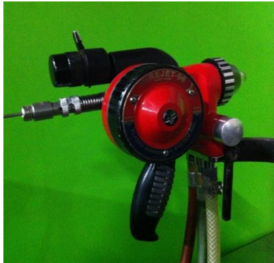
Figura 42. Pistola de proyección Térmica WIREJET-96 utilizada.
