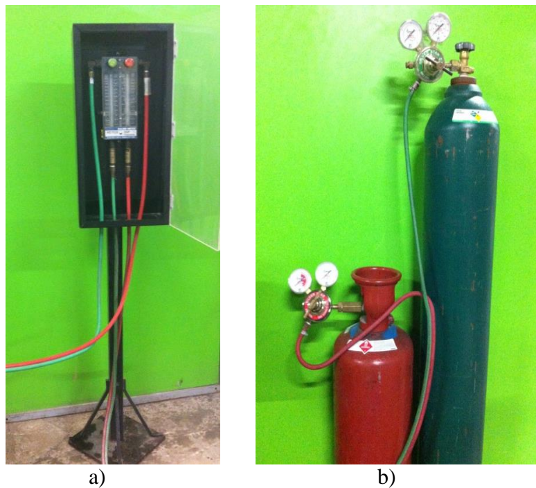
Figura 43. a) Flujómetro. b) Tanques de oxígeno y acetileno empleados.
