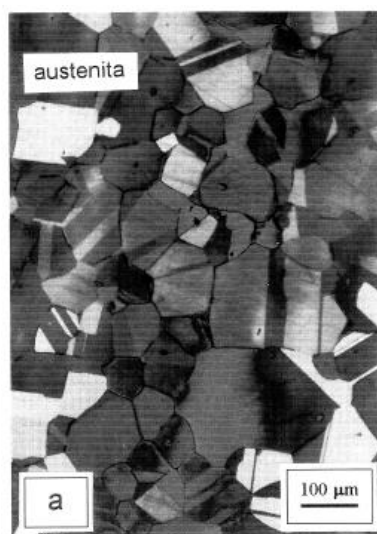
Figura 32. Micrográficas de aceros inoxidables obtenidas mediante la técnica de ataque colorado [31].
