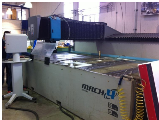
Figura 37. Cortadora por chorro con agua marca Flow, modelo MACH4 4020b.
