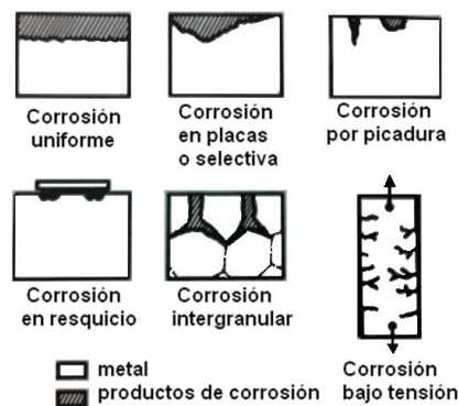
Figura 25. Representación esquemática de los distintos tipos de corrosión de acuerdo con la morfología del ataque [22].
