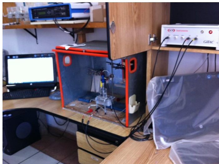
Figura 67. Arreglo experimental para la prueba EIS.
