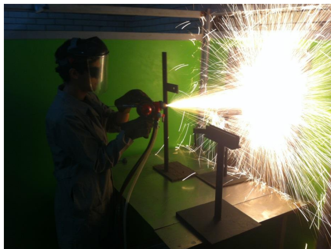
Figura 48. Proceso de proyección térmica.
