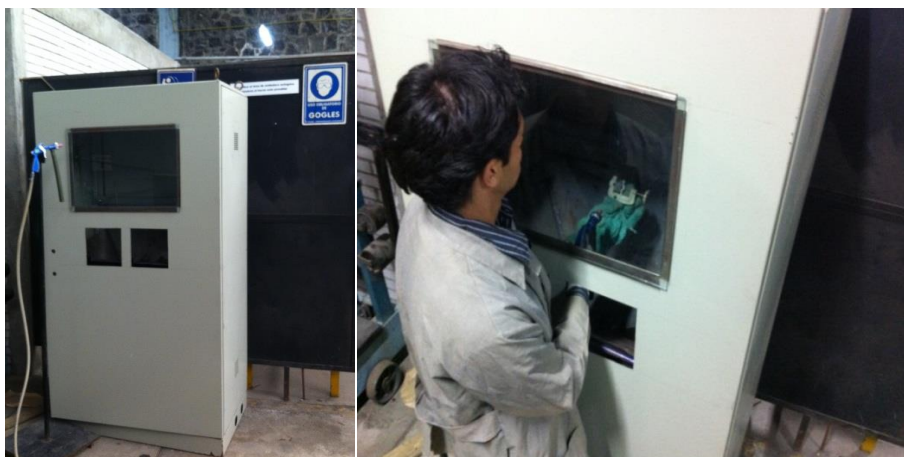
Figura 39. Cámara de granallado y equipo de seguridad empleado.
