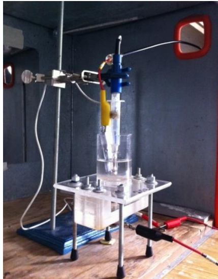
Figura 66. Conexión del equipo para el análisis (EIS).
