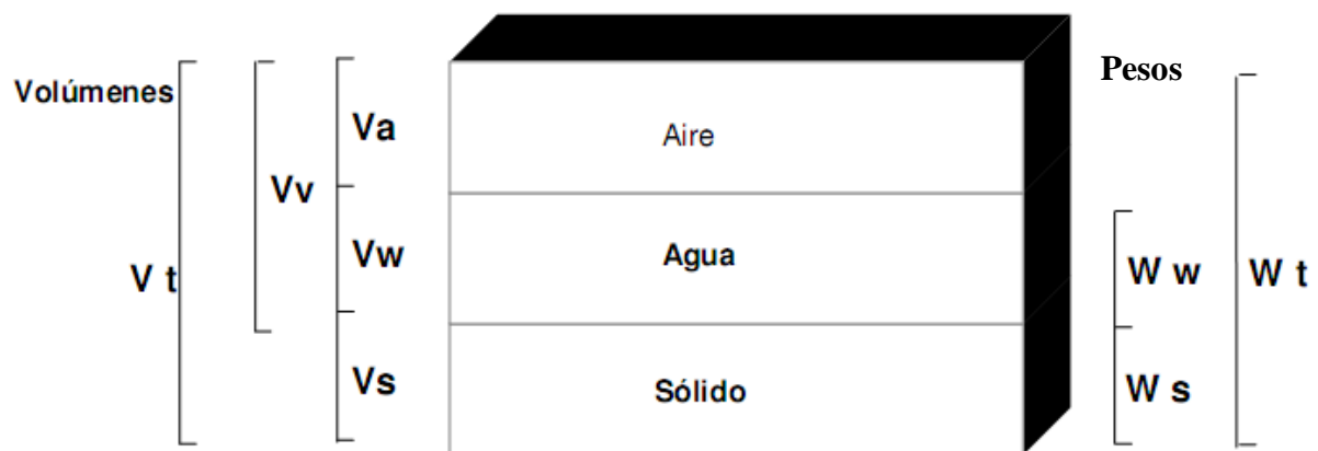
Figura 2.1 Diagrama de diferenciación de volúmenes y masas de una muestra de suelo.
