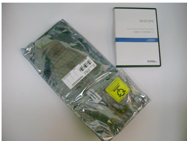
Figura A3. Tarjeta NI PCI-5152 y software NI-SCOPE.
