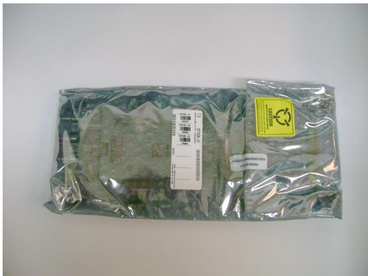
Figura A2. Tarjeta NI PCI-5152 empacada en su bolsa antiestática.
