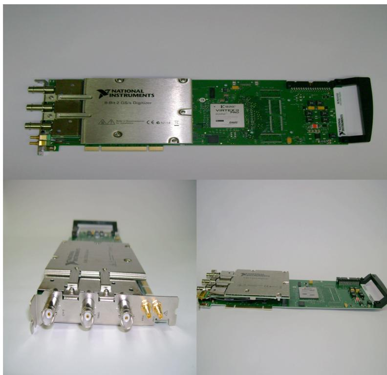
Figura A1. Diferentes vistas de la tarjeta NI PCI-5152.
