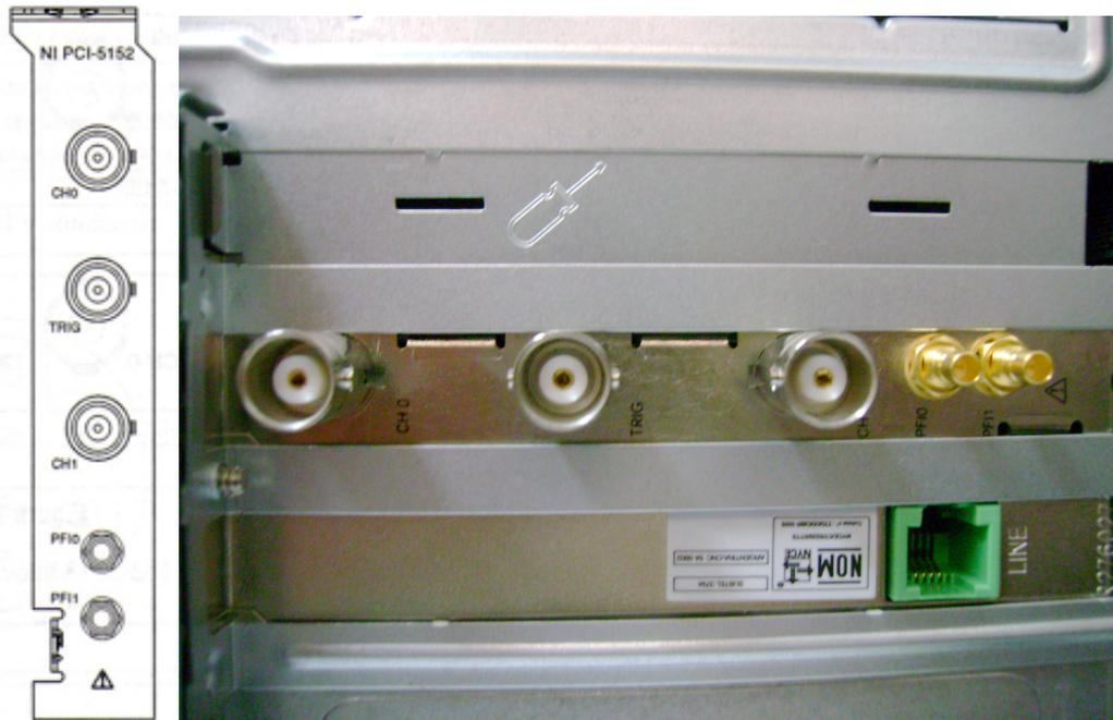
Figura A10. Panel frontal de una tarjeta NI 5152.
