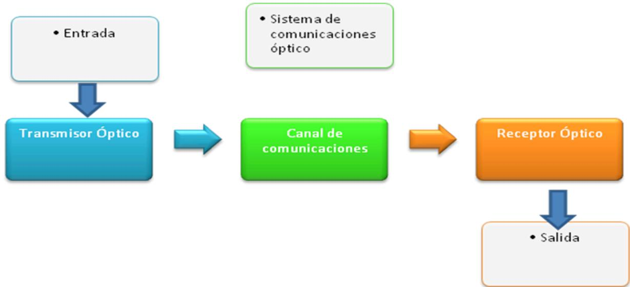
Figura 1.3 Diagrama de bloques de un sistema óptico de comunicaciones típico.
