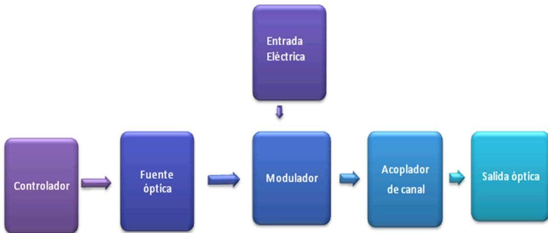
Figura 1.4 Diagrama de bloques de los componentes de un transmisor óptico.
