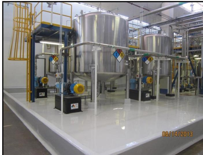
**Figura 2.12** Tanques de almacenaje de base blanca.
