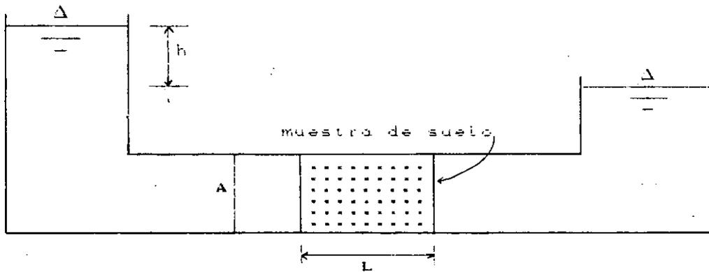
Fig. 5.1 Permeámetro de carga constante.
