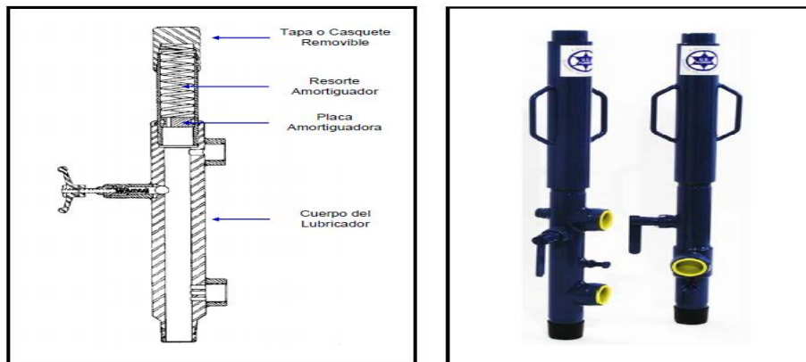
Fig. 2.12 Partes internas y externas típicas de un lubricador
