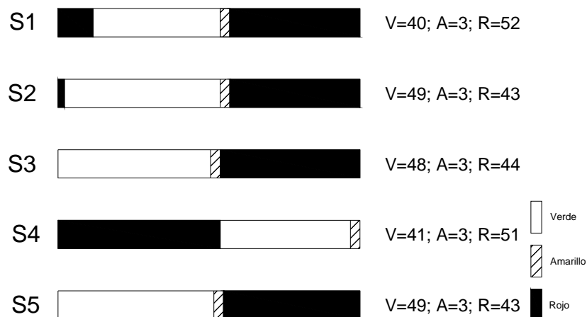
Figura 4.13 Distribución de los tiempos de semáforo en Intersección 3 Fuente: Elaboración propia
